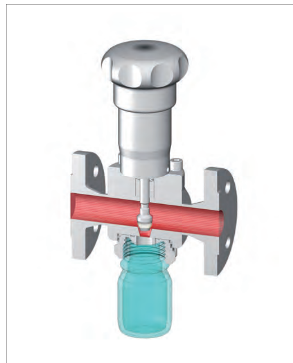
Prinzip des konischen Ventilsitzes
