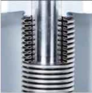
**4.** Mehrwandiger, vollumspülter Edelstahl-Faltenbalg, gegen Verdrehen gesichert, ausgelegt für 10.000 Lastwechsel; vollständig verschweißt
