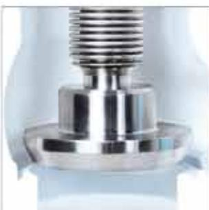
**6.** Drehbar gelagerter Ventilkegel mit konischer Dichtleiste aus gehärtetem Chromstahl 1.4021 bzw. gepanzert mit Stellite 6; Gehäuse Sitz gepanzert mit Edelstahl 1.4370 bzw. Stellite 21
